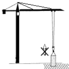
起吊被固定住的重物
