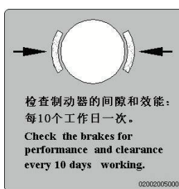
检查制动块的间隙
